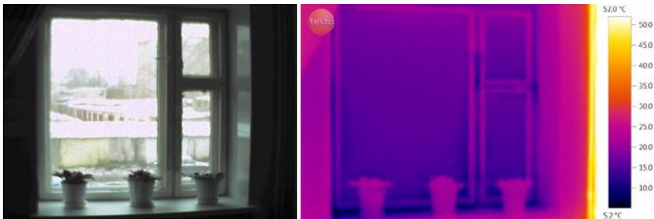
Рис. 3. Видимое (цифровое) и тепловое изображения окна в оконном проеме
